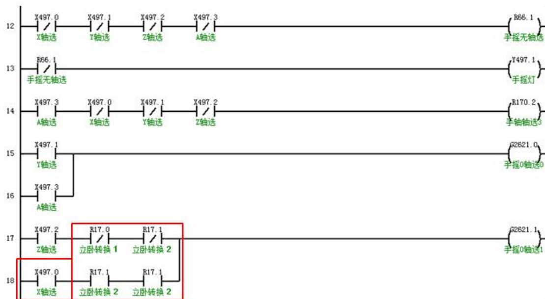
图 3-36-6 PLC 修改示例
