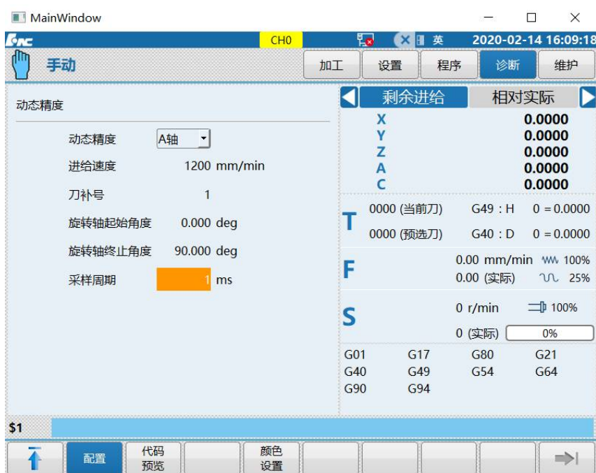
图 E-2 动态精度参数设置
