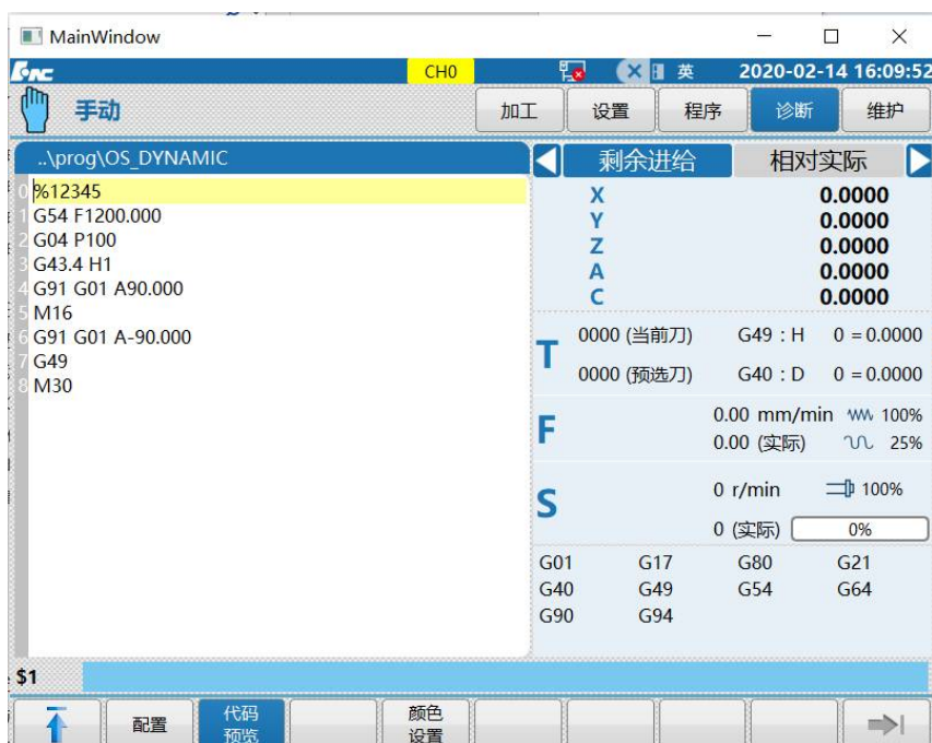
图 E-3 动态精度测试 G 代码
