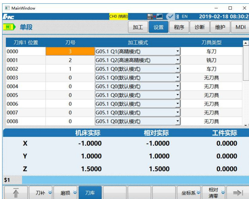
图 3-29 车铣复合刀号显示界面
