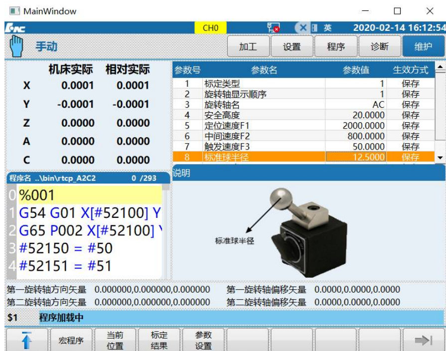
图 D-7 机床自动标定界面
