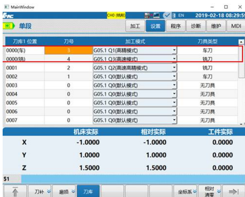
图 3-30 车铣复合刀号显示界面
