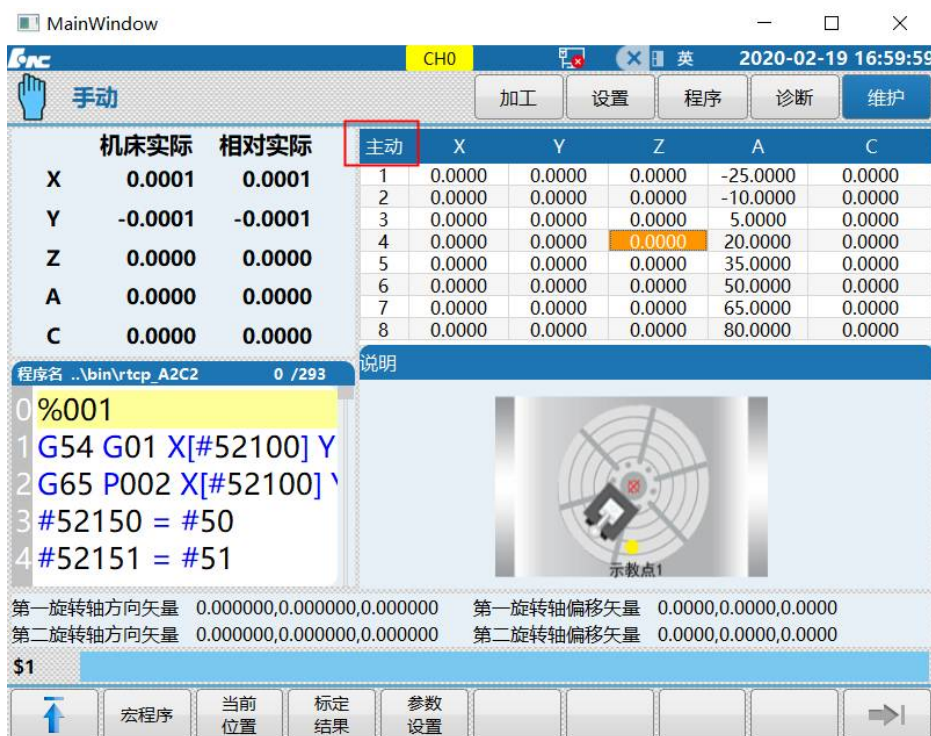
图 D-8 第一旋转轴试教点的采集
