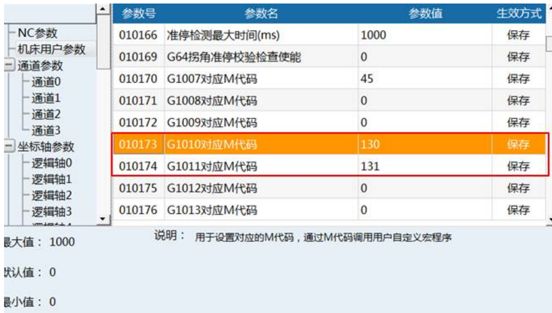
图 3-34 M 代码调用固定循环设置
